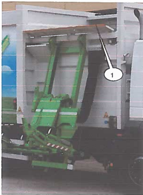
Figura 15 - pantalla de goma sobre la tolva de carga (1)
