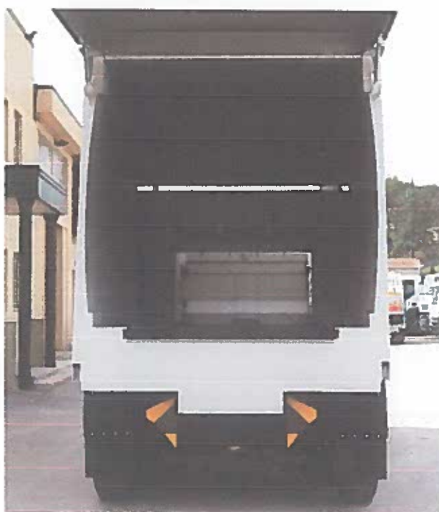
Figura 14- vista frontal de la placa eyectora y de la tolva en fase de carga
