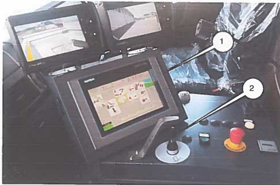
Figura 22 - consola de mandos (1) y joystick de mando (2)
