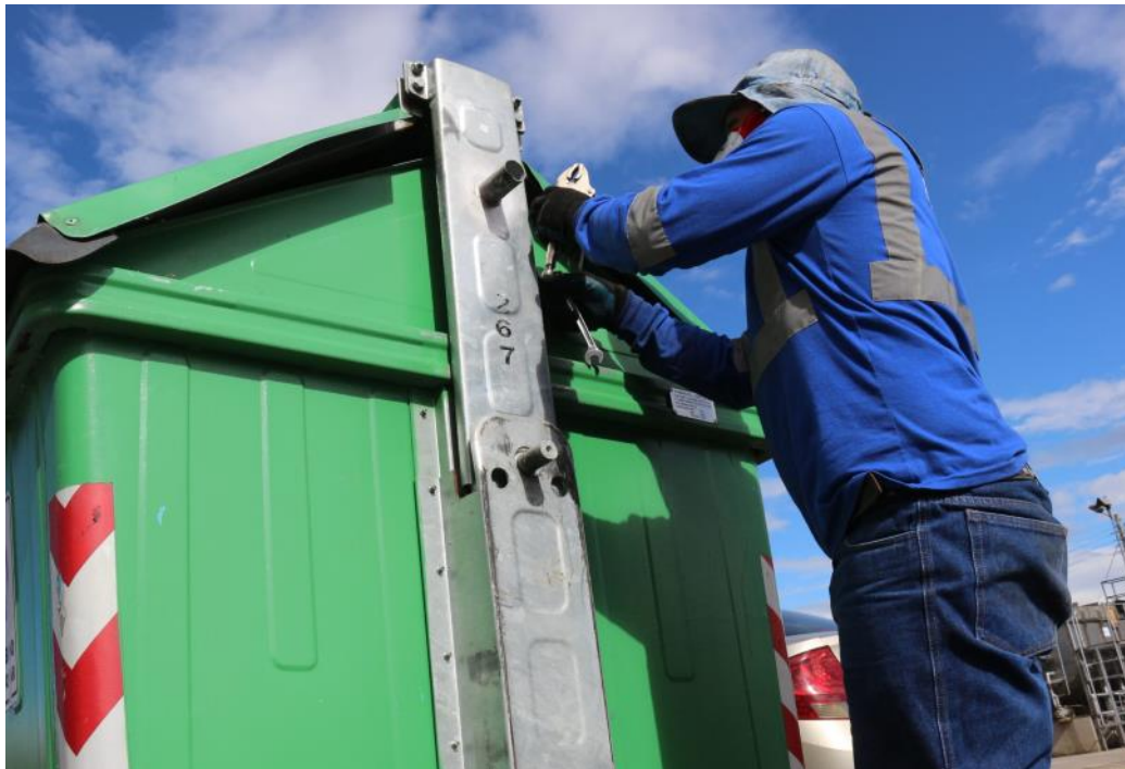
Imagen 13. Reparación de pedal de apertura de tapa de contenedor.
