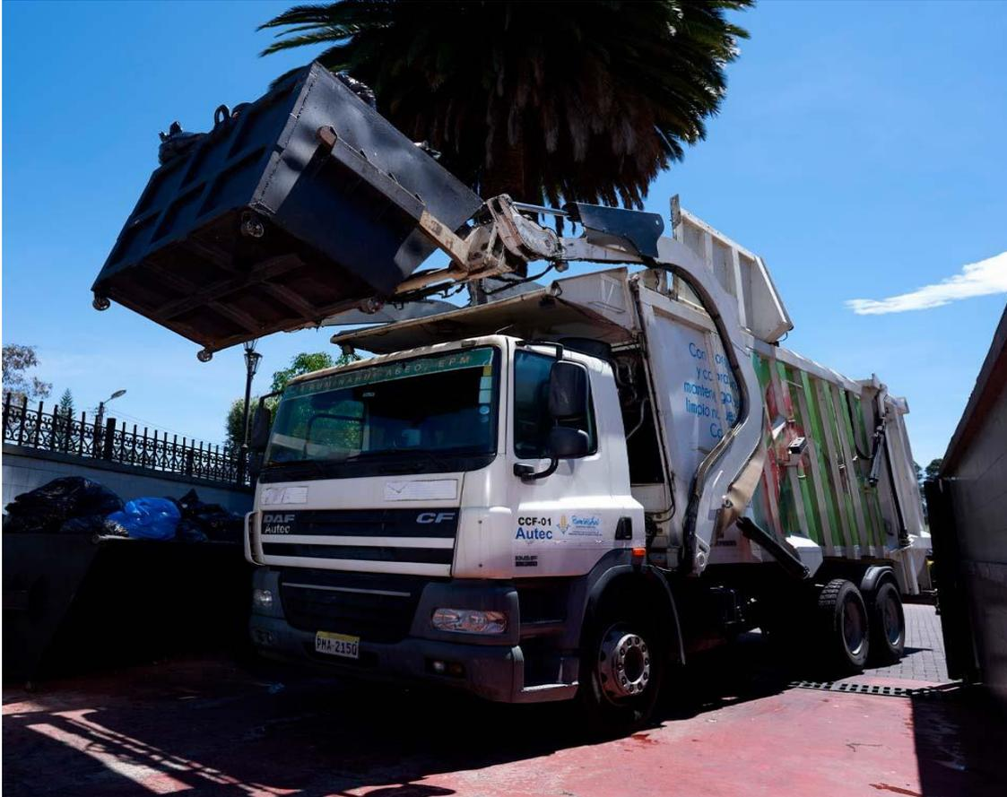
Imagen 5. Recolector de carga frontal realizado el vaciado de contenedor industrial.
