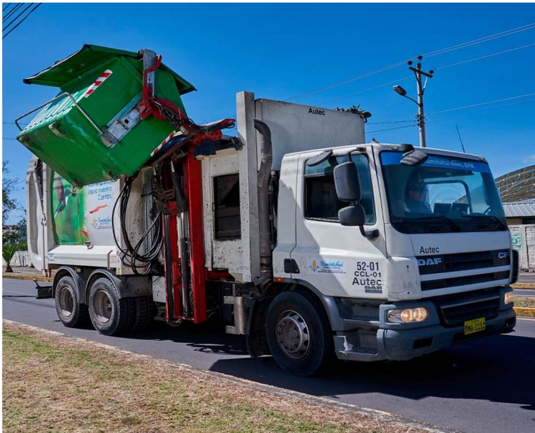
Imagen 3. Recolector de carga lateral en proceso de levante de contenedor
